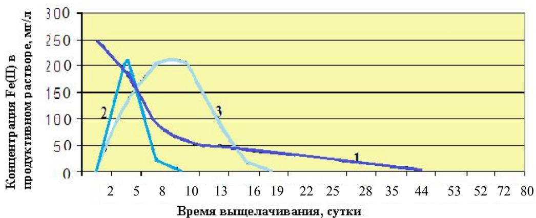
Рис. 13. Зависимость концентрации Fe(II) в продуктивном растворе от времени выщелачивания неокисленных руд: 1 ряд – без окислителя; 2 ряд – с перекисью водорода; 3 ряд – с нитритом натрия / Fig. 13. Dependence of the Fe(II) concentration in the productive solution on the leaching time of non-oxidized ores: 1 row – without an oxidizer; 2 row – with hydrogen peroxide; 3 row – with sodium nitrite
