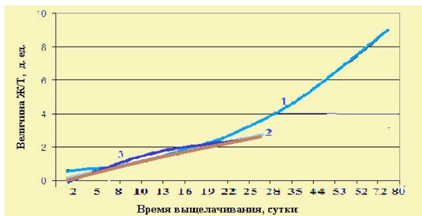
Рис. 9. Зависимость величины Ж/Т от времени выщелачивания неокисленных руд: 1 ряд – без окислителя; 2 ряд – с нитритом натрия; 3 ряд – с перекисью водорода / Fig. 9. Dependence of the W/T value on the leaching time of non-oxidized ores: 1 row – without oxidizer; 2 row – with sodium nitrite; 3 row – with hydrogen peroxide
