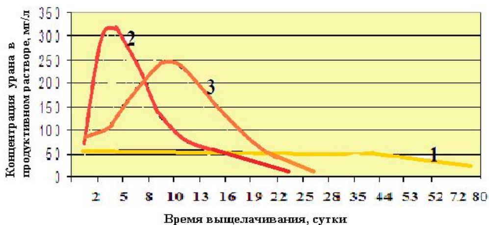
Рис. 11. Зависимость концентрации урана в продуктивном растворе от времени выщелачивания неокисленных руд: 1 ряд – без окислителя; 2 ряд – с перекисью водорода; 3 ряд – с нитритом натрия / Fig. 11. Dependence of the uranium concentration in the productive solution on the leaching time of non-oxidized ores: 1 row – without an oxidizer; 2 row – with hydrogen peroxide; 3 row – with sodium nitrite
