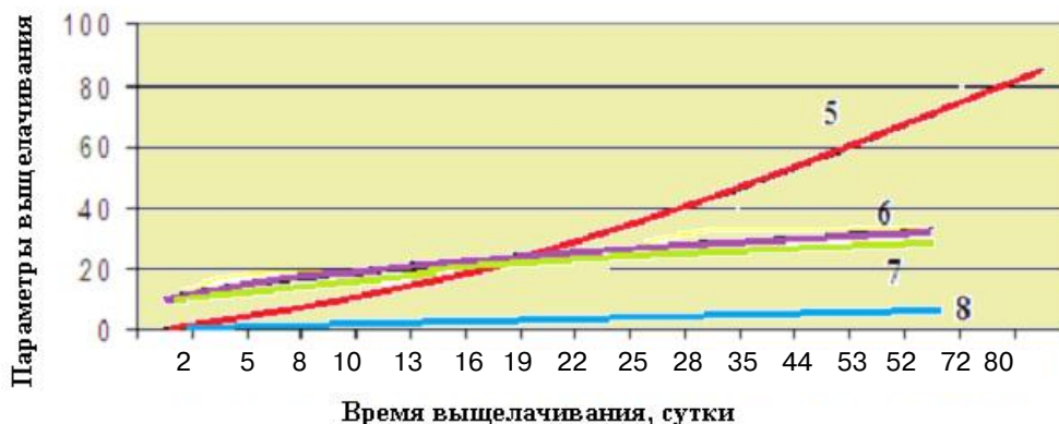
Рис. 2. Зависимость показателей выщелачивания неокисленной руды от времени выщелачивания без окислителя: 5 ряд – извлечение урана, %; 6 ряд – расход серной кислоты, кг/т; 7 ряд – концентрация серной кислоты, мг/л; 8 ряд – Ж/Т / Fig. 2. Dependence of the leaching indicators of non-oxidized ore on the time of leaching without an oxidizer: Row 5 – uranium extraction, %; Row 6 – sulfuric acid consumption, kg/t; Row 7 – sulfuric acid concentration, mg/l; Row 8 – W/T
