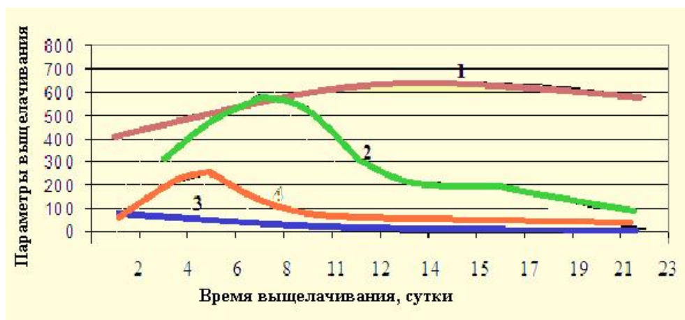
Рис. 3. Зависимость показателей выщелачивания неокисленной руды от времени выщелачивания с перекисью водорода: 1 ряд – ОПВ, мВ; 2 ряд – Fe (III), мг/л; 3 ряд – Fe (II), мг/л; 4 ряд – концентрация урана, мг/л / Fig. 3. Dependence of the leaching indicators of non-oxidized ore on the time of leaching with hydrogen peroxide: 1 row – OPV, mV; 2 row – Fe (III), mg/l; 3 row – Fe (II), mg/l; 4 row – uranium concentration, mg/l
